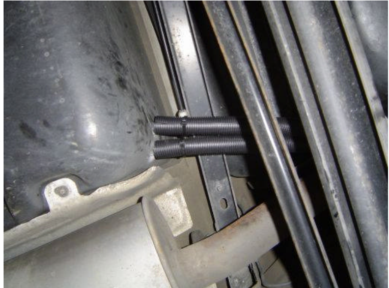
Pöl-Vorlauf und -Rücklauf an der Radmulde mit Schutzrohr
