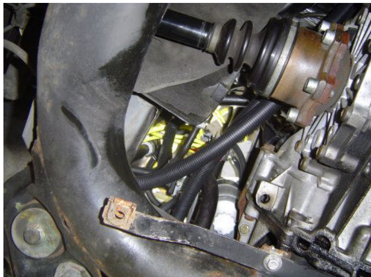
Pöl-Vorlauf und -Rücklauf an unter dem Motorraum mit Schutzrohr
