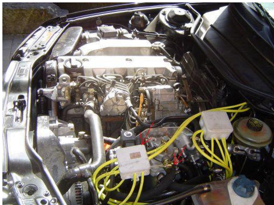
Motorraum mit gekennzeichnetem Vor- und Rücklauf
