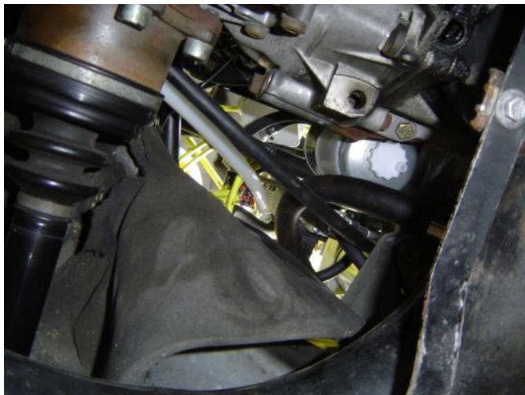
Pöl-Vorlauf und -Rücklauf unter dem Motorraum ohne Schutzrohr
