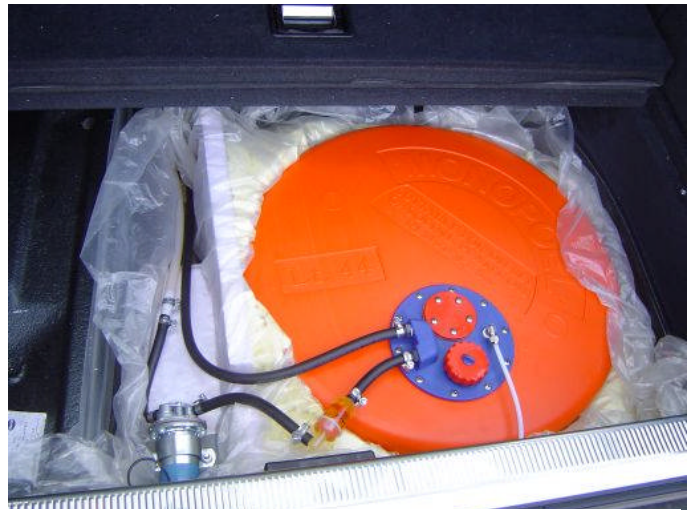
Der Pöltank mit Vorfilter und Pumpe
